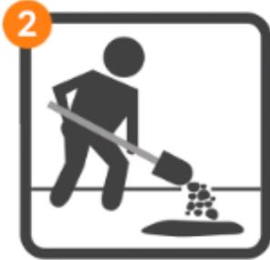
*AÑADIR EL PRODUCTO EN CAPAS DE 2" DE ESPESOR COMO MÁXIMO, PARA OBTENER UN BUEN RESULTADO EN LA COMPACTACIÓN.*
