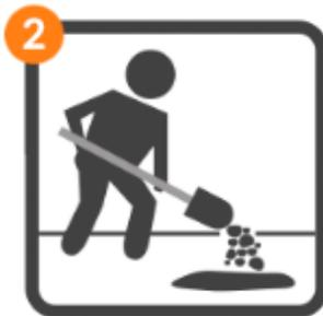
*AÑADIR EL PRODUCTO EN CAPAS DE 2" DE ESPESOR COMO MÁXIMO, PARA OBTENER UN BUEN RESULTADO EN LA COMPACTACIÓN.*
