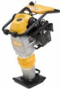
Este Equipo es utilizado para Compactación de Base, Sub-Base o Afirmado, nosotros NO indicamos utilizarlo para compactación de Asfaltado en grandes áreas, pues el producto final no es regular y el área de actuación del equipo (zapata) golpea un área pequeña y deja marcas.
